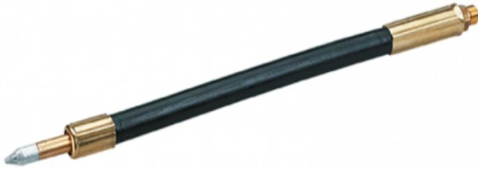
SILVENT 620 - 650 tiene la boquilla montada en una manguera flexible Flexblow que permanece en la posición deseada al soplar incluso con presiones altas. Las mangueras Flexblow de SILVENT están disponibles en 4 longitudes estándar. La manguera Flexblow tiene rosca de conexión macho de 1/8".
